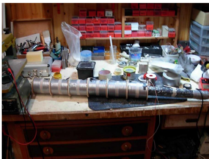
Fig. 1 – Realizzazione dell'antenna ad altissima induttanza.
